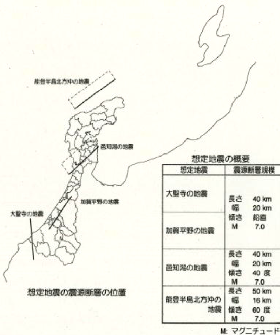
図 4つの想定地震の震源断層の位置
