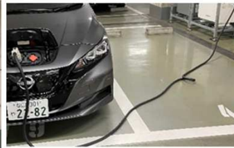
1-6 耐震性の高いモデル住宅、防災井戸、V2Hの例
