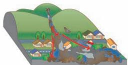
山腹、川底の石や土砂が長雨や集中豪雨などによって一気に下流へと押し流される現象です。時速は20~40kmにもなり、人家などを一瞬のうちに壊滅させてしまう場合があります。
