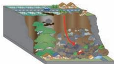
地中にしみ込んだ水分が土の抵抗力を弱め、雨や地震などの影響によって急激に斜面が崩れ落ちる現象です。突然起きるため、人家の近くで発生すると逃げ遅れる人も多く、大きな人的被害をもたらします。
