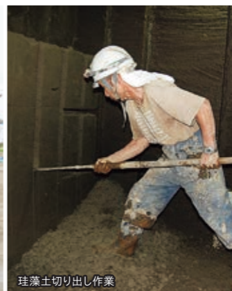
珪藻土切り出し作業
