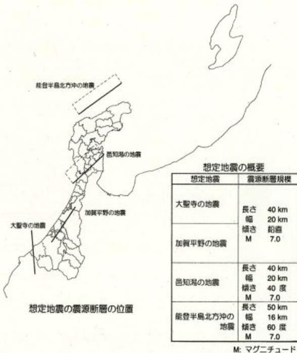
図 4つの想定地震の震源断層の位置
